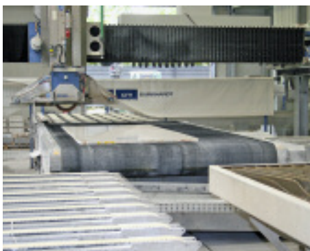
Bild 5: Sägeanlage CSA 598 WJ von Burkhardt-Hensel mit Bandtisch, Wasserstrahlanlage und Hochregalanbindung
