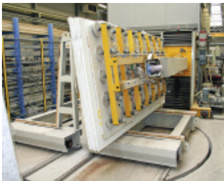
Bild 1: Der Manipulator entnimmt eine Platte vom Plattenwagen, fährt sie zur Förderstrecke des Scanners und legt sie dort ab.
