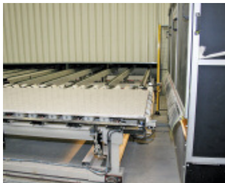
Bild 2: Eine Rohplatte hat nach der Digitalisierung den Scanner verlassen und wird in das Hochregallager befördert.
