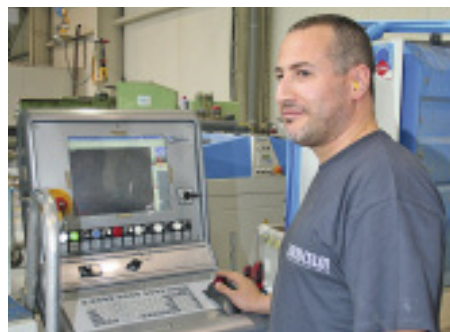
Bild 3: Taheri Rached erhält an der Wasserstrahlanlage Idro Line über Makros Vorschläge zur Maschinenfahrweise, die er meist vollständig übernimmt.
