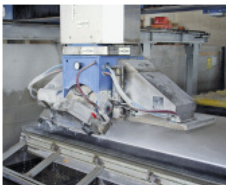
Bild 4: Zu Beginn werden die Gehrungsschnitte ausgeführt.
