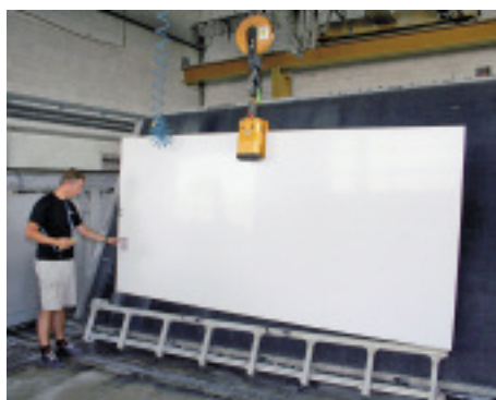
Bild 3: Die Rohplatten werden beim Aufbänken auf einen hochklappbaren Anschlag gestellt und sind so bereits positioniert.
