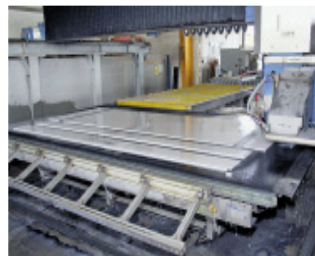
Bild 5: Die zugesägten Werkstücke gelangen von der Sägeanlage über eine Rollenbahn zu dem im Hintergrund befindlichen Kantautomat Edilux.
